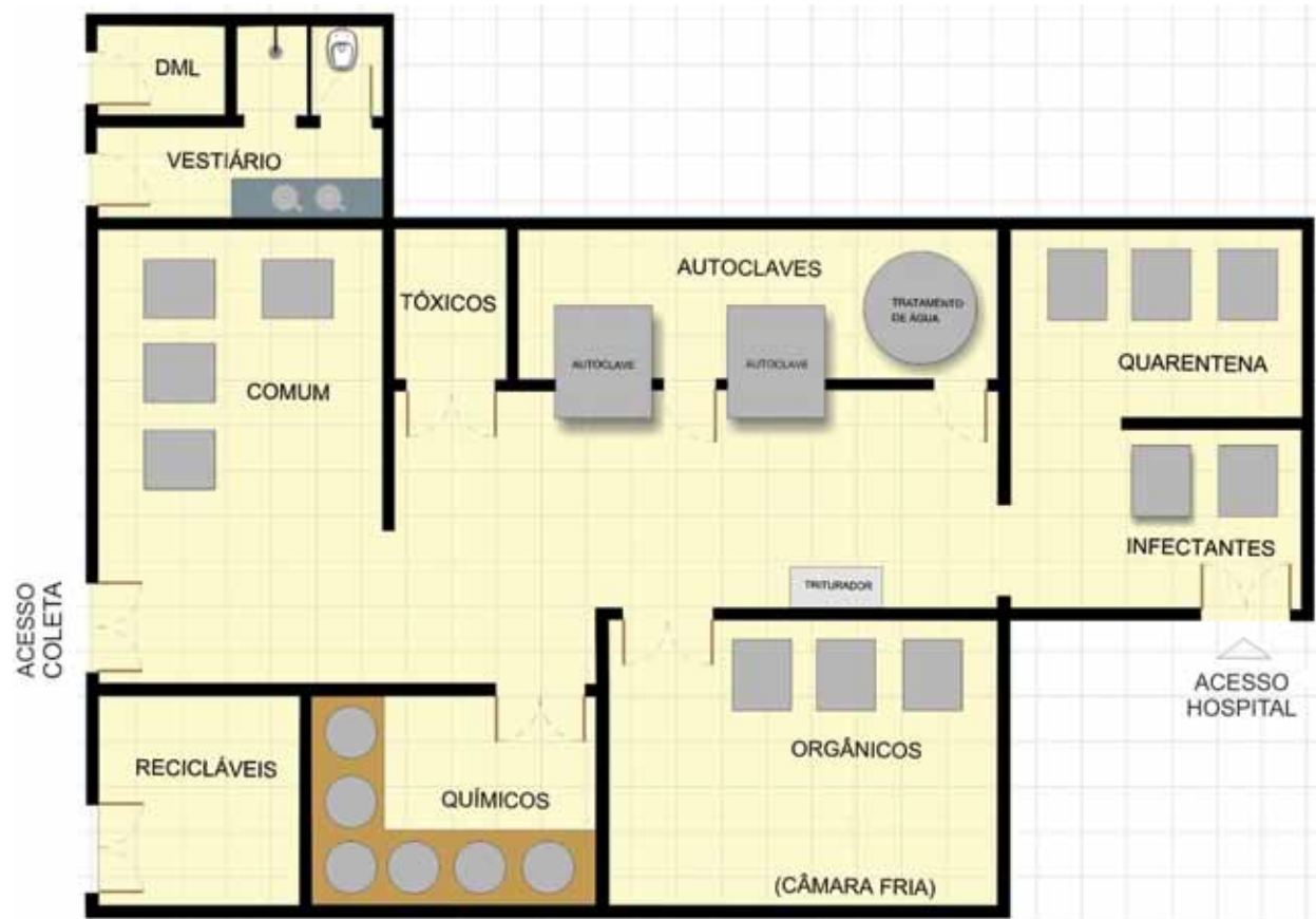
Figura 3.1.1: Esquema de central de tratamento de resíduos hospitalares
