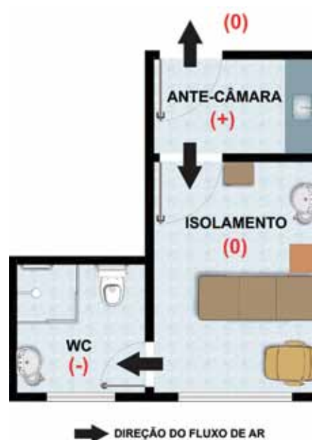
Figura 4.3.1: Esquema de pressão do ar em isolamento Fonte: GEA-hosp (2014), segundo Khoe (2009)
