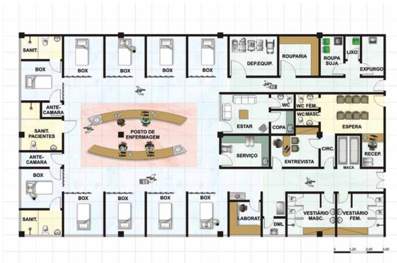
Figura 4.3.5: Modelo típico de UTI com apoio à frente e salão ao fundo Fonte: Alves, Andrade e Oliveira (2003)
