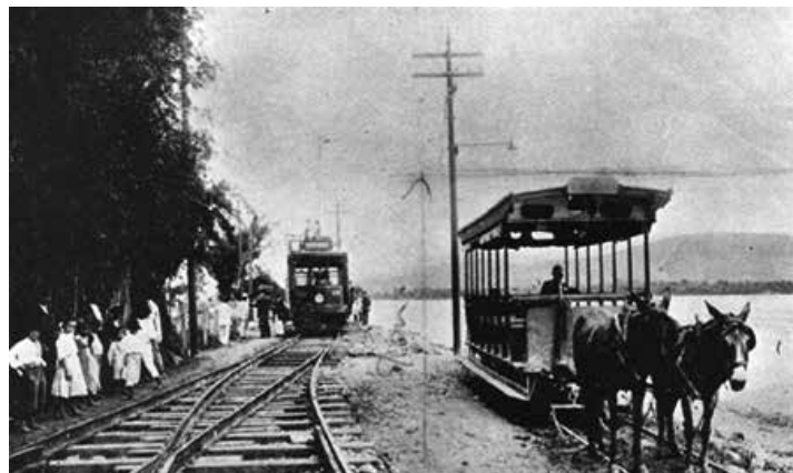
Figura 1 – Um bonde de tração elétrica circulando ao lado de um bonde puxado a burros. Foto do início do século XX
