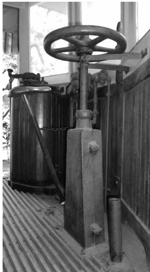
4b) Roda similar a volante que servia para acionar o freio mecânico
