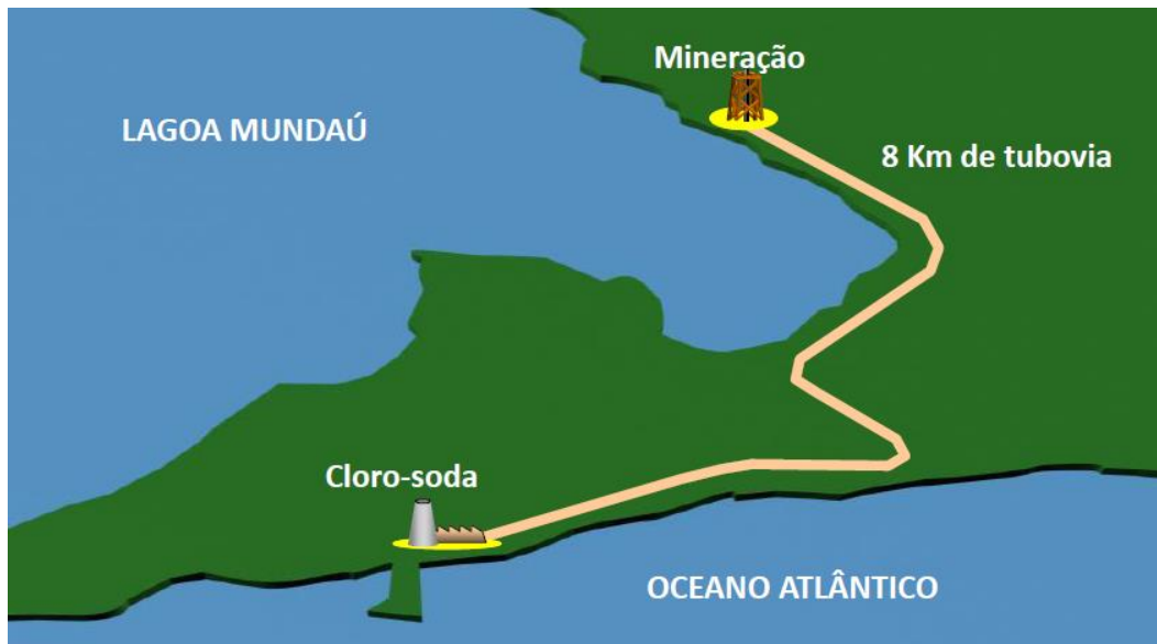
Figura 39 - Desenho esquemático da tubovia que transporta a salgema dos poços produtores para a planta de cloro-soda.
