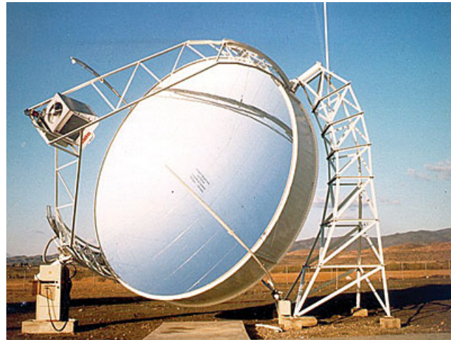
Figura 19 – Sistema concentrador parabólico com seguidor polar
