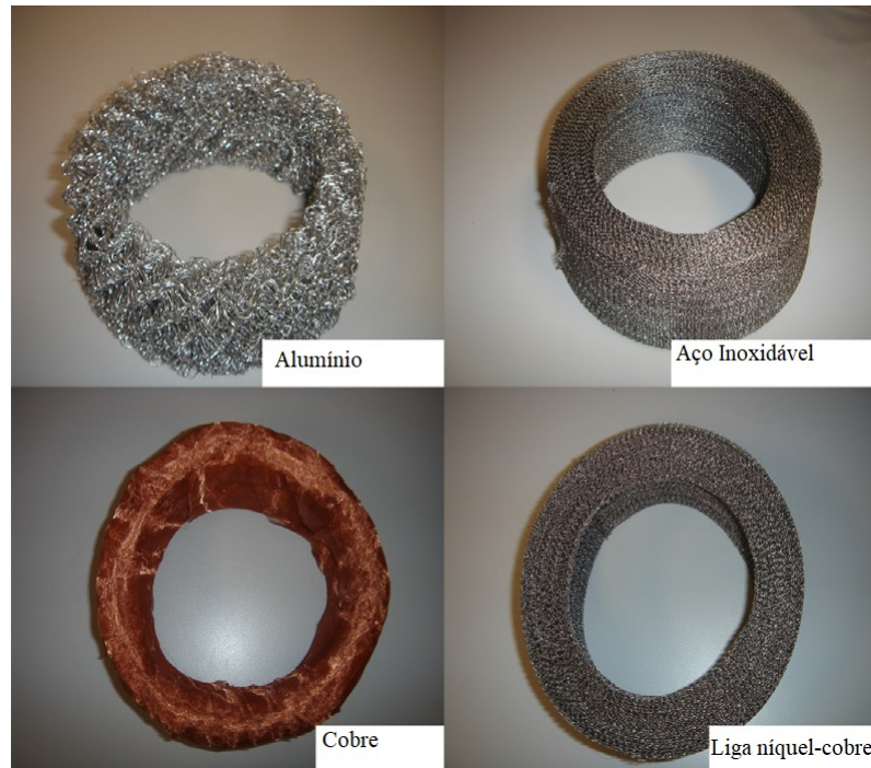
Figura 26 – Regeneradores anulares de malha de fios de vários materiais
