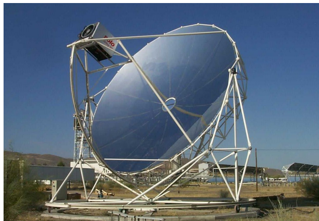
Figura 18 – Sistema de concentrador parabólico com seguidor Azimutal-Elevatório e suporte carrossel
