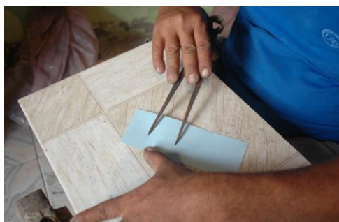
Figura 14: marcação para efetuar a Brocação das espadas.
