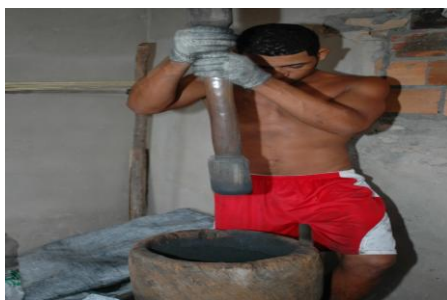
Figura 8: Rosival R. dos Santos, 18, pilando a pólvora Foto: Nádia Conceição
