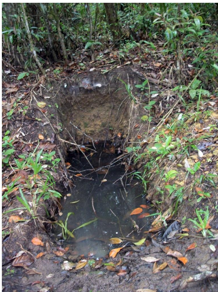
Figura 15 – Perfil alagado em virtude da baixa permeabilidade do horizonte litoplíntico (Perfil 2)
