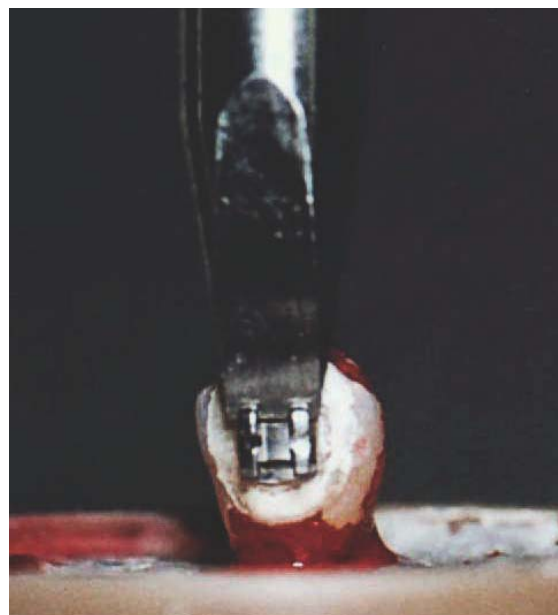
FIGURA 2 - Adaptação da base do braquete à ponta ativa da máquina de ensaios.
