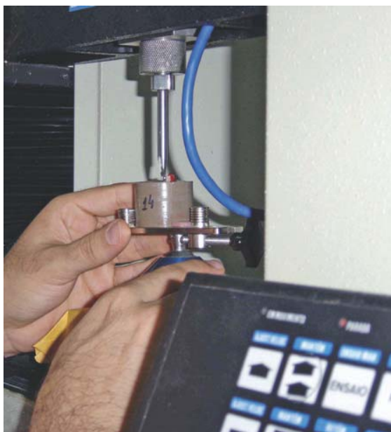
FIGURA 1 - Posicionamento do corpo-de-prova na máquina de ensaios EMIC.
