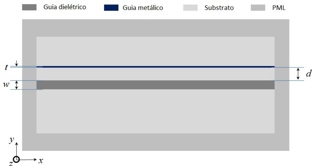
Figura 3.1: Esquema do acoplador híbrido plasmônico composto por guia de onda dielétrico e metálico, envoltos por substrato.
