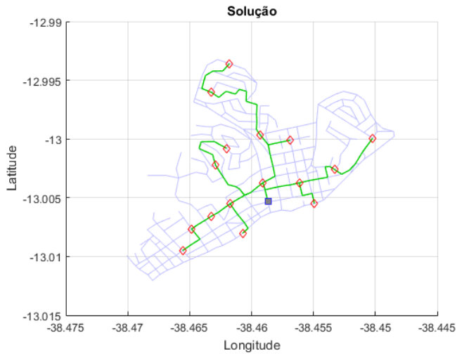
Figura 6.38 – Solução AG para Topologia Centralizada – Tipo 1 para cenário não denso.
