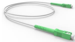
36 - CORDÃO MONOFIBRA CONECTORIZADO BLI A/B G-657A SC-APC/SC-APC 2.5M - LSZH - BRANCO - D3
