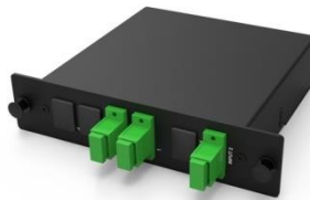
33 - SPLITTER ÓPTICO MODULAR LGX 1X2 50/50 G.657A SC-APC/SC-APC
