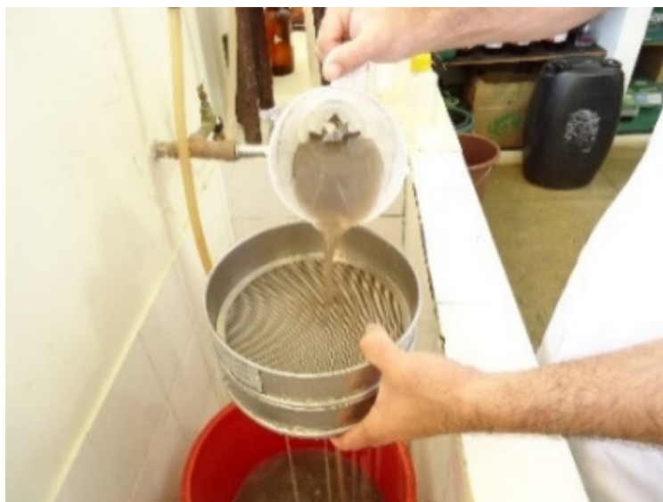
Figura 24 – Peneira de malha 0,85mm sobre a peneira de malha 0,059mm
