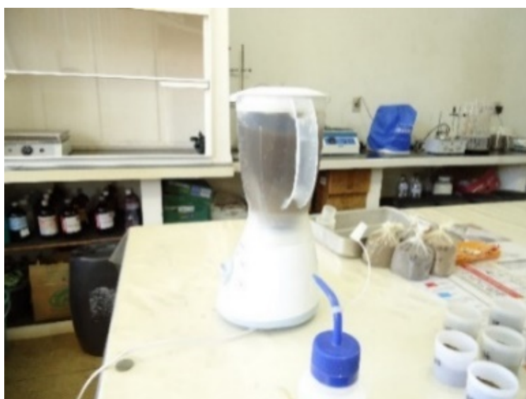
Figura 23 – Agitação em liquidificador com 1litro de água
