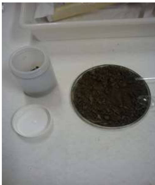
Figura 21: Aspecto de uma amostra de sedimento após o processo de liofilização.
