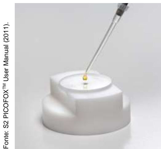
FIGURA 25: Disco porta-amostra de sílica sobre o suporte de teflon como guia para adição da alíquota da amostra.
