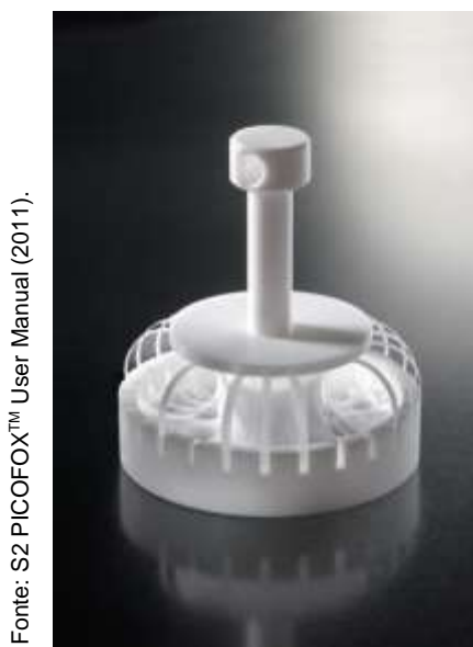
FIGURA 26: Suporte de teflon contendo discos de quartzo para serem descontaminados.
