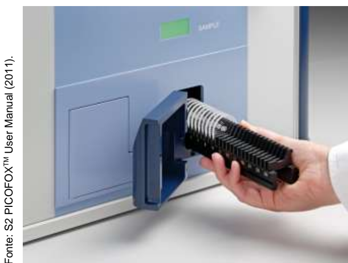
FIGURA 27b: Carretel contendo discos porta-amostras sendo introduzido no equipamento.
