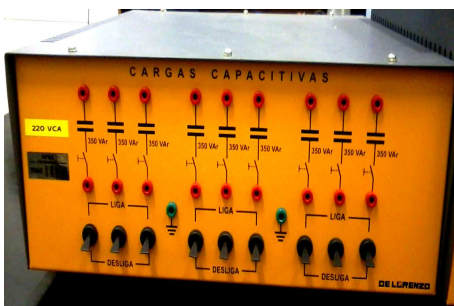
(e) Banco de capacitores
