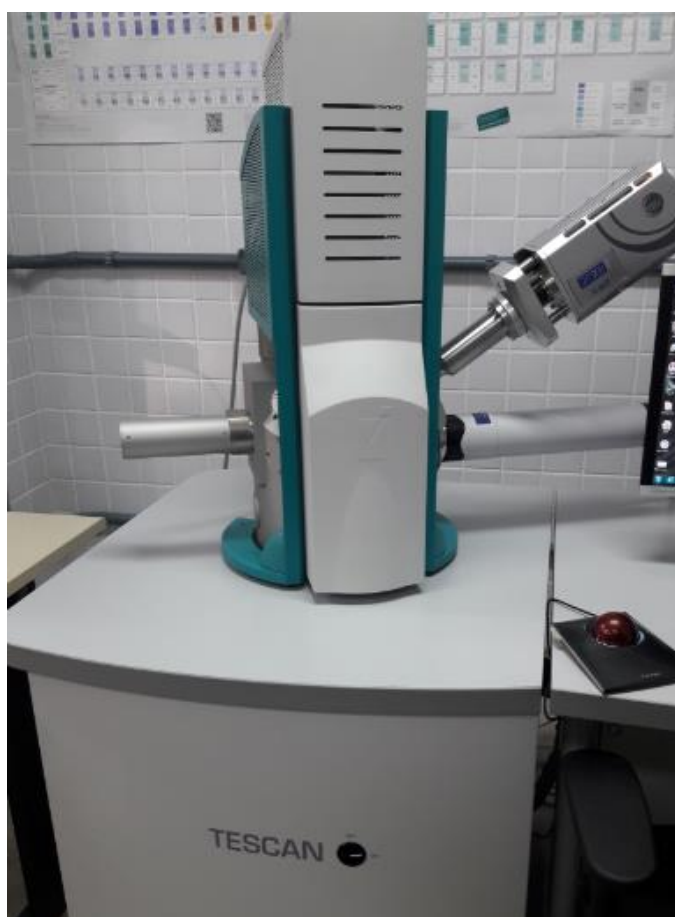
Figura 32 - Microscópio Eletrônico de Varredura (MEV) modelo Vega 3 LMU – TESCAN.
