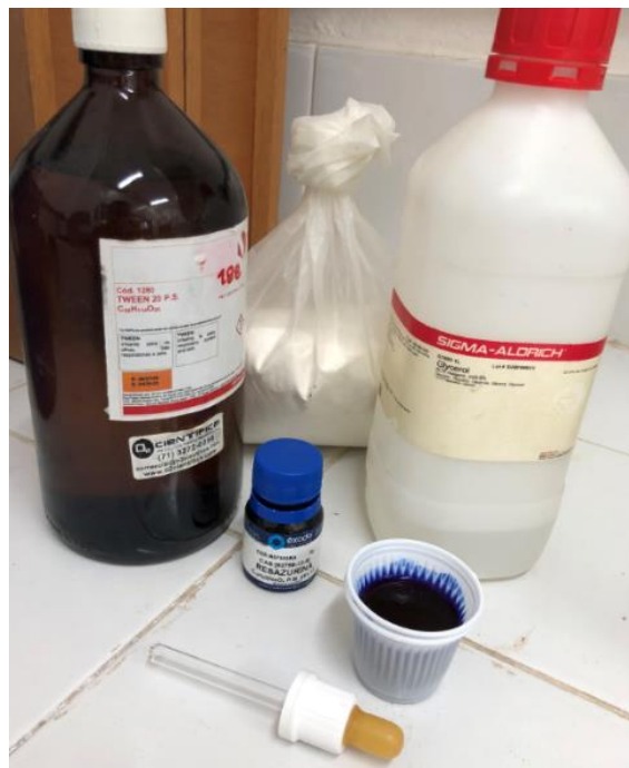
Figura 33 - Materiais utilizados para verificação da capacidade fotocatalítica através da tinta indicadora de resazurina.
