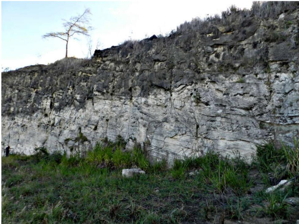
Figura 40 Frente NW - SE da Mina IV. Camadas coquinóides com geometrias tabular, lenticulares e sigmoidais progradantes.
