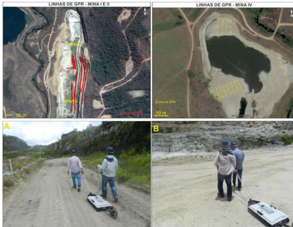
Figura 59 Aquisição de Linhas de GPR nas minas principal e IV. A) Aquisição de linhas *Strike* (N-S), e B) Aquisição de Linhas *Dip*.
