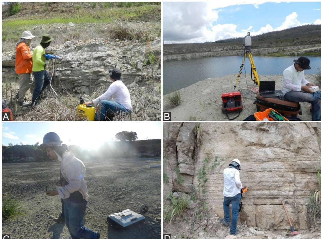
Figura 1 Ferramentas utilizadas para aquisição de dados complementares: A) Coleta de *plugs* com perfuratriz; B) Aquisição de nuvens de pontos com *Laser Scanner*; C) Aquisição de linhas de GPR; D) Coleta de perfis com Raio Gama.
