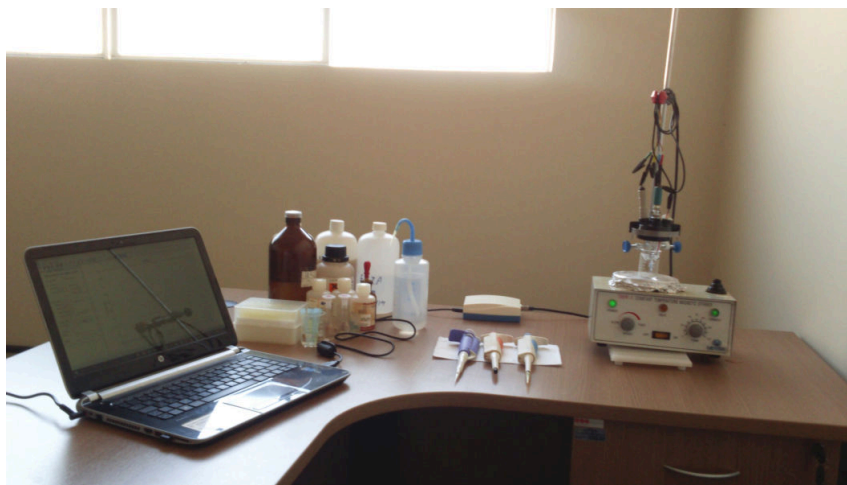
Figura 8 Fotografia do sistema de análise com o potenciostato/galvanostato portátil.
