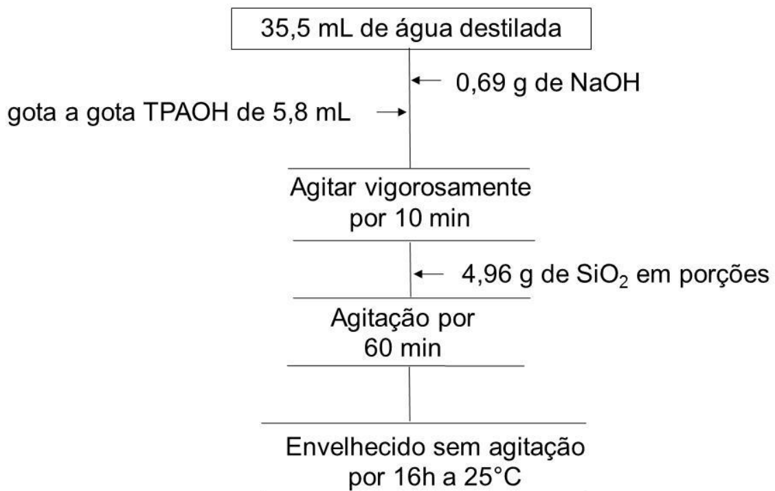
Figura 11. Fluxograma do gel de sementes do zeólito de topologia MFI.
