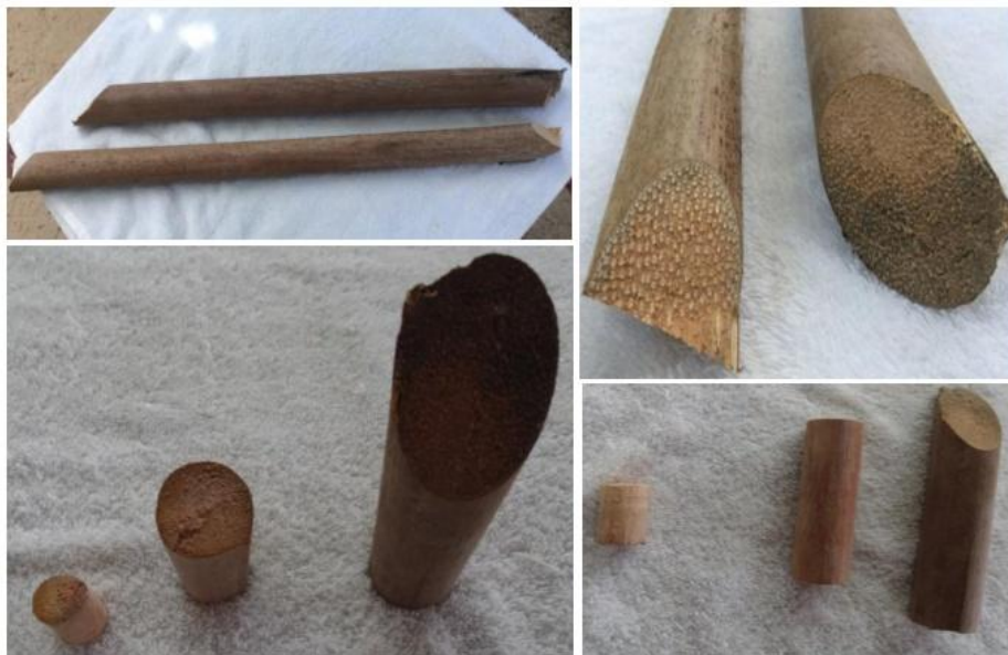
Figura 4 - Visualização do caranã por vários ângulos (material de vedação do tubo)
