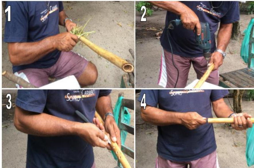
Figura 7 - Etapas iniciais do processo de confecção da flauta de imbaúba: 1 - Raspagem da casca fibrosa; 2 - furando os orifícios dos dedilhados; 3 - moldando os orifícios com a faca; 4 - retirando os gomos internos com a barra rosca.
