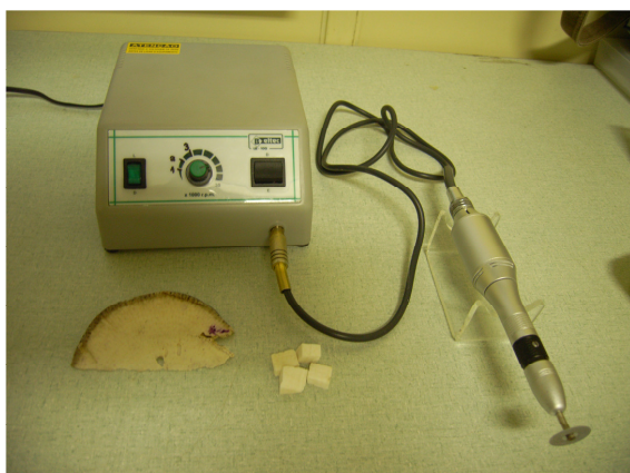
Figura 6- Motor de bancada e partículas da amostra na forma de cubos.
