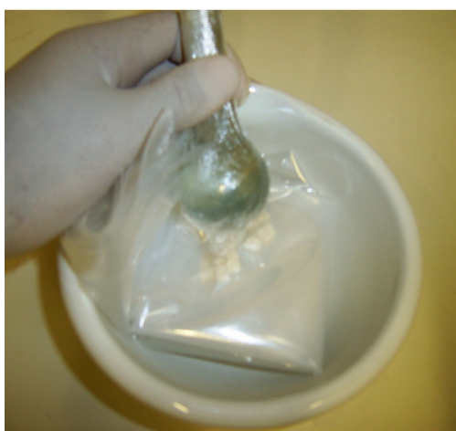
Figura 1- Foto ilustrando as amostras envolvidas em sacos plásticos para moagem em gral e pistilo de porcelana.
