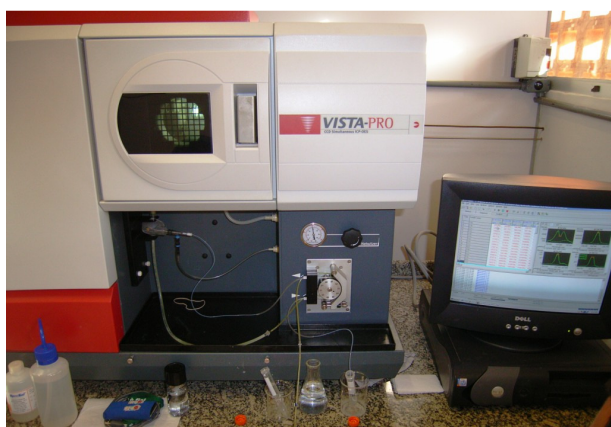
Figura 14- Espectrômetro de emissão óptica com plasma de argônio indutivamente acoplado (VARIAN, Mulgrave, Austrália).
