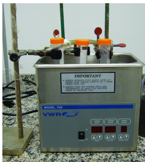
Figura 7- Aparelho utilizado para banho ultrassônico das amostras.
