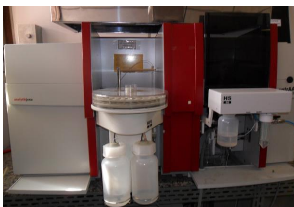
Figura 5. Espectrômetro com fonte contínua de alta resolução usado para as medidas de absorção molecular de NO.
