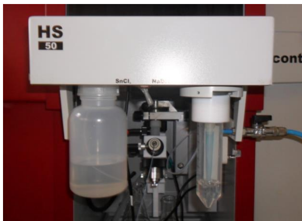
Figura 11. Sistema HS 50, acoplado ao HR-CS AAS, usado para a geração química de NO a partir da redução de nitrito.
