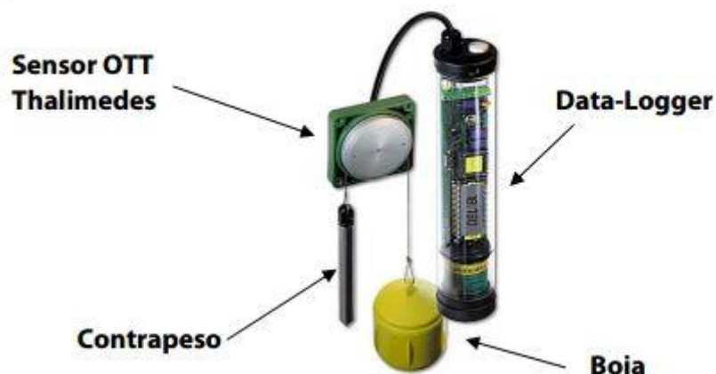
Figura 16 - Marégrafo digital Thalimedes do tipo boia e contrapeso utilizado para aquisição dos dados de maré.
