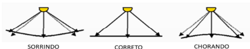
Figura 6 - Perfis de ensonificação dos feixes em situações de medição incorreta dos perfis de velocidade do som na coluna d'água (NORMAM-25, 2014)
