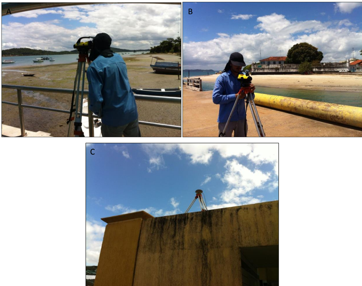
Figura 15 - Nivelamento Geométrico realizado nas estações A) Madre de Deus e B) Ilha de Itaparica com uso de Nível Eletrônico e C) Base RTK.
