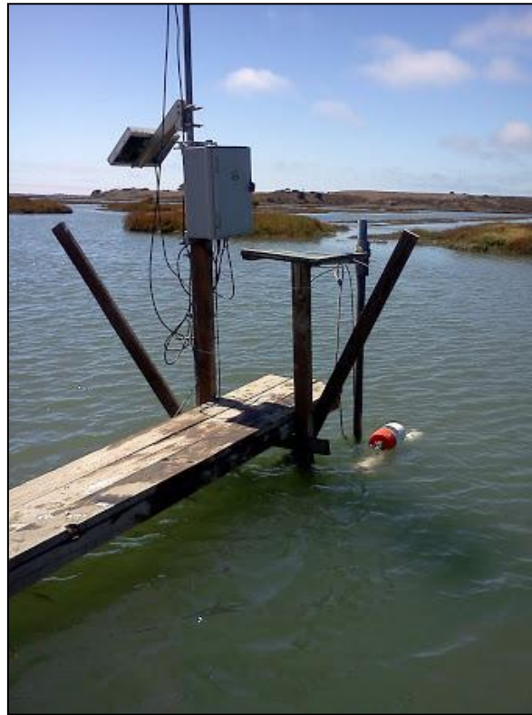
Figura 36 – Sonda presa a uma boia na estação SM em momento de maré alta no dia 23 de agosto de 2012 às 9:02 da manhã.
