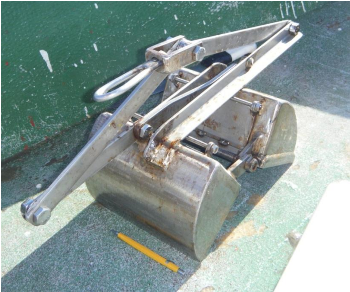
Figura 9. Amostrador Van Veen de aço inox utilizado para coleta de amostra biológica.
