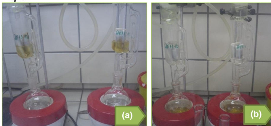
Figura 12 – Extração em Soxhlet. (a) solvente rico em extrato e (b) solvente transparente após extração
