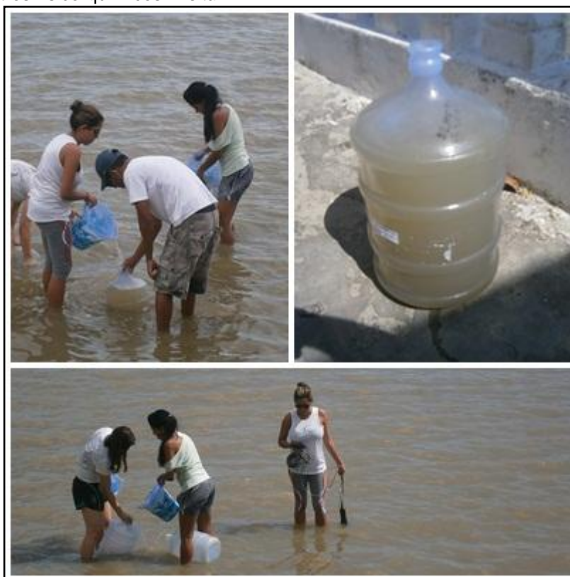
Figura 5: Coleta de água para obtenção do material particulado em suspensão e mediada de parâmetros físico-químicos in situ .
