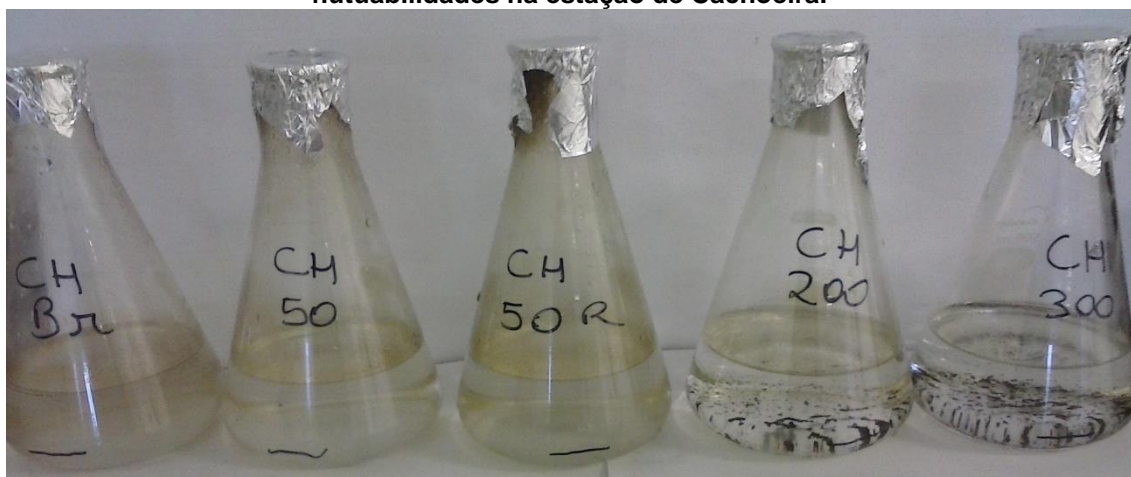
Figura 9 – Alíquotas da estação de Maragogipe utilizadas para determinar a quantidade de OSAs formados na coluna (armazenados em béqueres) e no fundo (armazenados nos próprios erlenmeyers).
