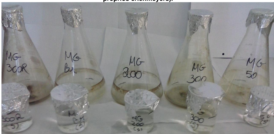
Figura 9 – Alíquotas da estação de Maragogipe utilizadas para determinar a quantidade de OSAs formados na coluna (armazenados em béqueres) e no fundo (armazenados nos próprios erlenmeyers).
