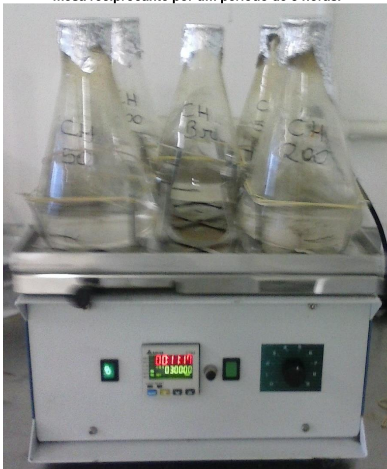
Figura 7 – Erlenmeyers, contendo água salina, óleo e sedimento, sendo agitados na mesa reciprocante por um período de 3 horas.
