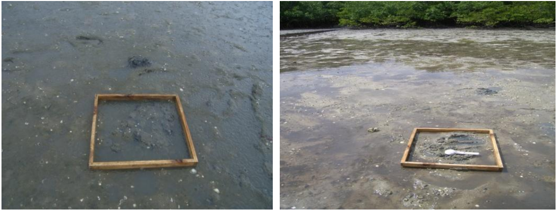
Figura 5: Coleta das amostras de biota e sedimento com o auxílio de espátula plástica.
