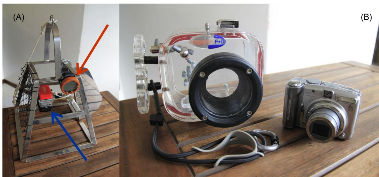
Figura 10: Equipamentos empregados na tomada das imagens submarinas: (A) estrutura de aço inoxidável onde foram acoplados a câmera GoPro Hero2 (seta azul) e o profundímetro Suunto Zoop (seta vermelha) para tomada de imagens remotamente; e (B) câmera Canon A720IS e caixa estanque Croma FD empregados na tomada de imagens por mergulhador.
