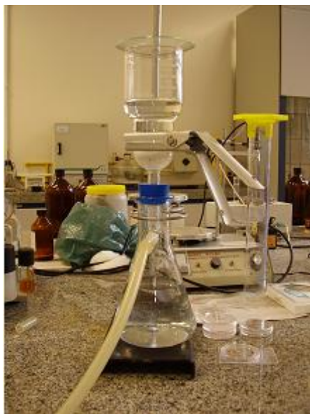
Figura 10: Esquema de filtragem de água para análise de CO e metais no MPS e de fósforo na água.
