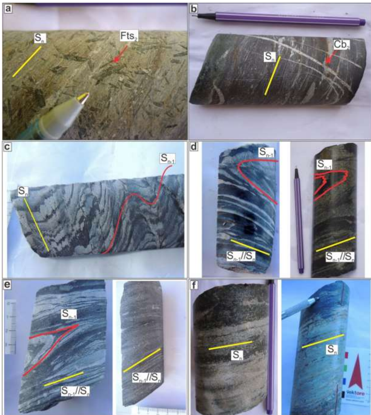
Fig. 5. Amostras de testemunhos de sondagem: (a) xisto máfico com porfiroblastos de ferri-tschermakita 2 (Fts 2 ) truncando a foliação S n ; (b) xisto máfico com foliação S n truncada por veios de carbonato (Cb 2 ); (c) de itabirito quartzoso micro a mesobandado com foliação S n-1 truncada pela S n ; (d) itabirito anfibolítico micro a meso bandado; (e) itabirito carbonáticos micro a mesobandado com xistosidade S n-1 //S n ; (f) rochas carbonatossilicáticas com mesobandamento e xistosidade S n indicada em amarelo.
