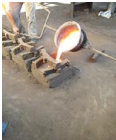
Figura 23b – Vazamento Y
