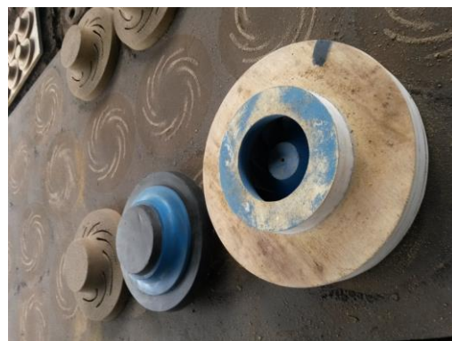
Figura 15b - Macho/Modelo/ Caixa de macho
