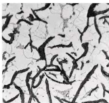
Figura 9 - Microestrutura do ferro fundido cinzento
