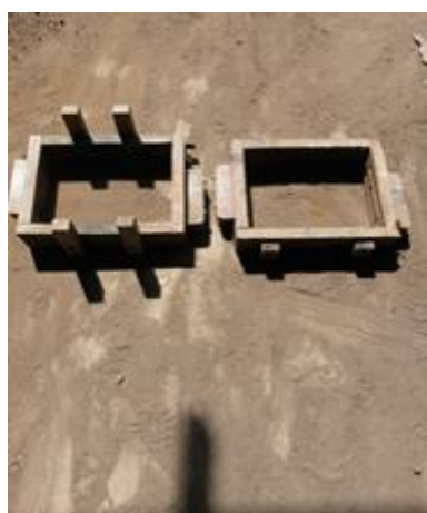
Figura 17a – Caixa de moldagem
