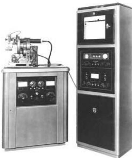
**Figura 2.2:** Primeiro modelo comercial de um espectrofotômetro por dispersão de ondas-
