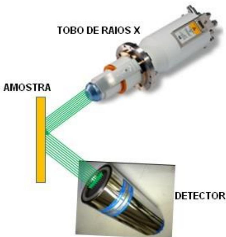
**Figura 2.7:** Modelo esquemático de um espectrofotômetro por dispersão de ondas ED-FRX .
