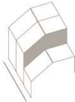
Figura 97 | Empena lateral com recorte comum e coroamento angular triangular de duas águas. Também conhecida por Oitão ou Outão. (desenho do autor)
