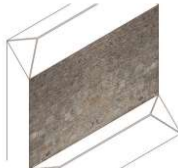
Figura 139 | Empena lateral com tratamento de superfície texturizada e cega. Empena em alvenaria de granito sem materiais de revestimento. (desenho do autor)
