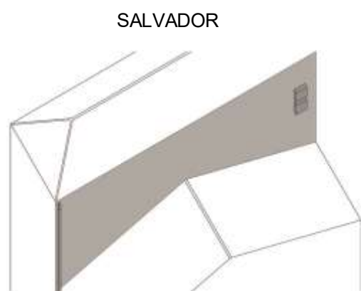
Figura 154 | Empena lateral com destaque de valor funcional. Empena lateral com instalações prediais diversas (ex: ar-condicionado, coletores de águas pluviais, fiações elétricas e aparelhos de TV). Os diferentes tipos de instalações podem ocorrer simultaneamente ou apenas com um tipo. (desenho do autor)
