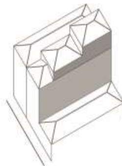
Figura 104 | Empena lateral com recorte comum e coroamento plano de água-mestra e pisos suplementares recuados e sobrepostos. (desenho do autor)
