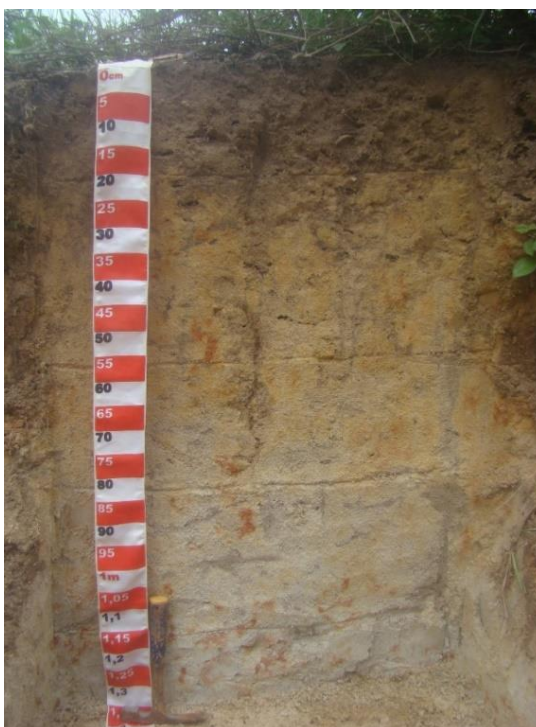
Figura 28: Perfil 16, Argissolo Vermelho-Amarelo Distrófico abrupto, em encosta convexa dos Tabuleiros Costeiros Preservados.
