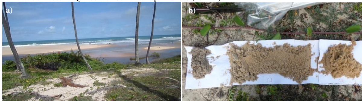
Figura 44: a) Área de terraço arenoso onde foi realizada a tradagem (Perfil 1); b) Amostras referentes a cada horizonte do Neossolo Quartzarênico no Terraço Arenoso (Perfil 1).
