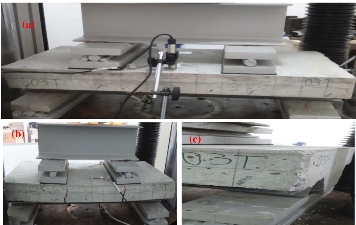
Figura 56: Amostra RM75-NI01 antes da ruptura (a) e após ruptura; (b) fissuradas e (c) deslizamento relativo.
