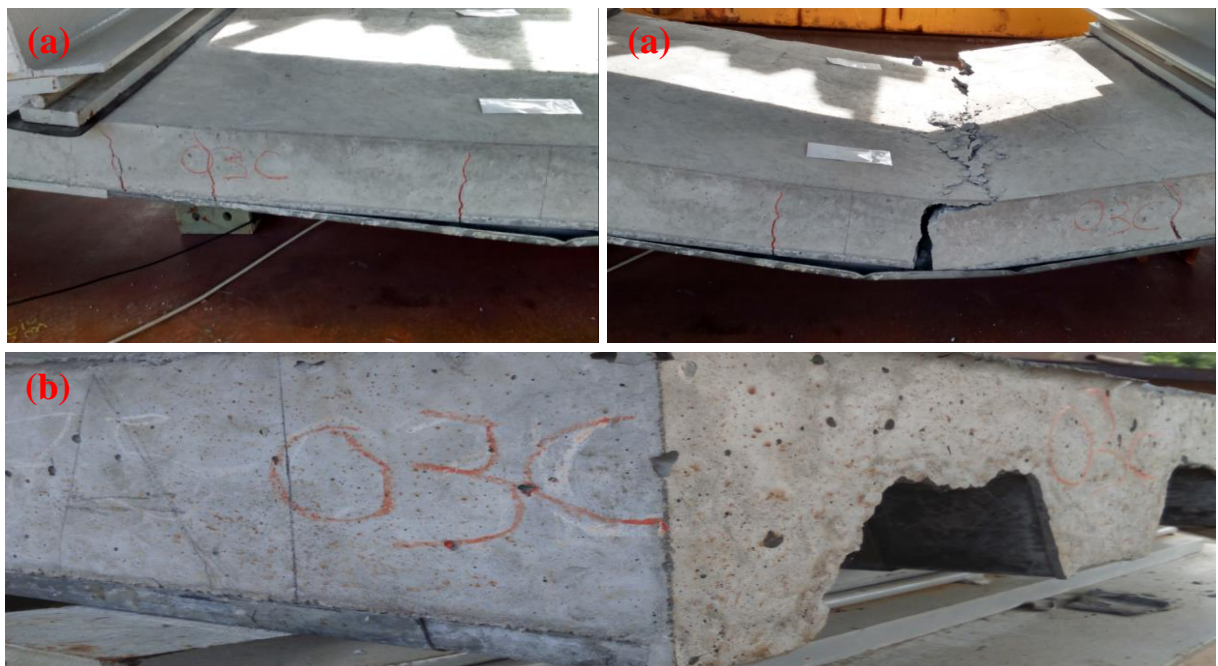
Figura 88: Fissuras (a) e deslizamento relativo (b) após ruptura da amostra RM75-03 C.
