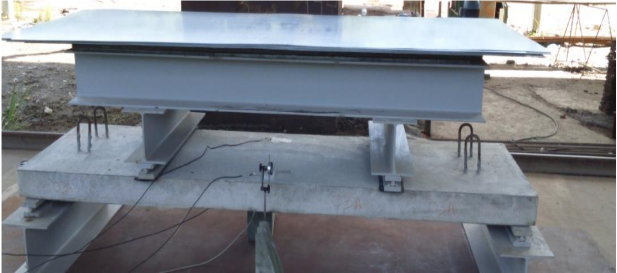
Figura 85: Esquema de carregamento das lajes RM75.
