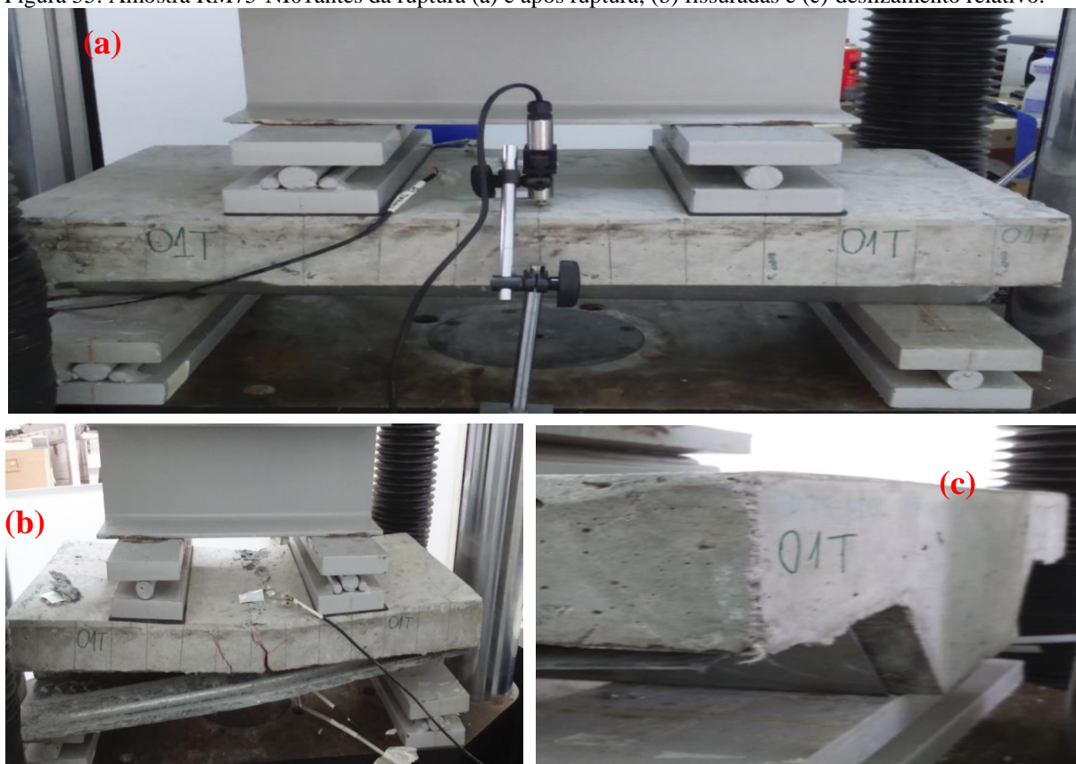
Figura 55: Amostra RM75-NI01 antes da ruptura (a) e após ruptura; (b) fissuradas e (c) deslizamento relativo.
