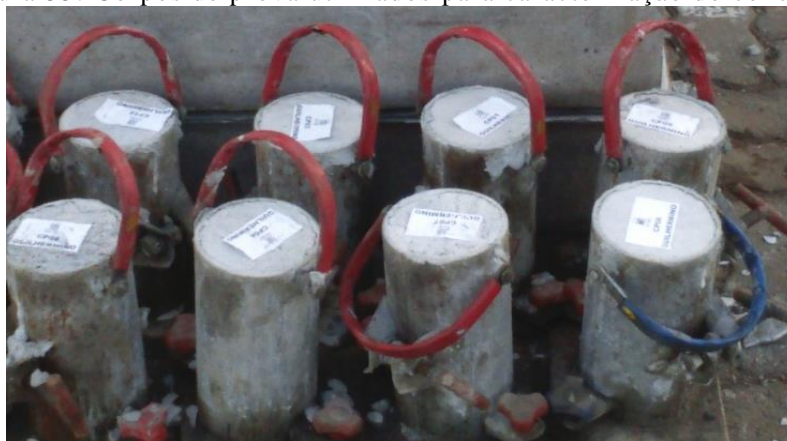
Figura 35: Corpos de prova utilizados para caracterização do concreto.
