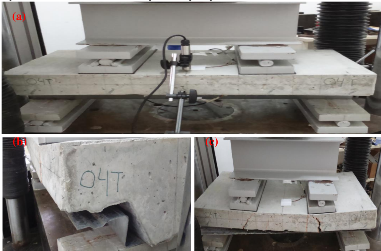
Figura 58: Amostra RM75-NI03 antes da ruptura (a) e após ruptura; (b) fissuradas e (c) deslizamento relativo.
