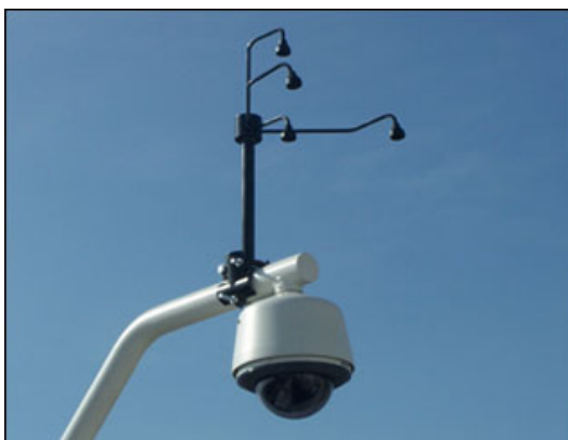
Figura 1 – Sistema de detecção de disparos de armas de fogo, Senti da Safety Dynamics (DYNAMICS, 2017)
