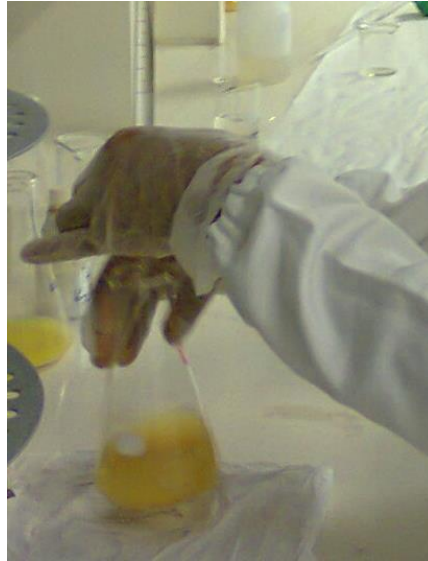
Figura 23- Etapa final da titulação para quantificação do cloreto – coloração amarelo pardo
