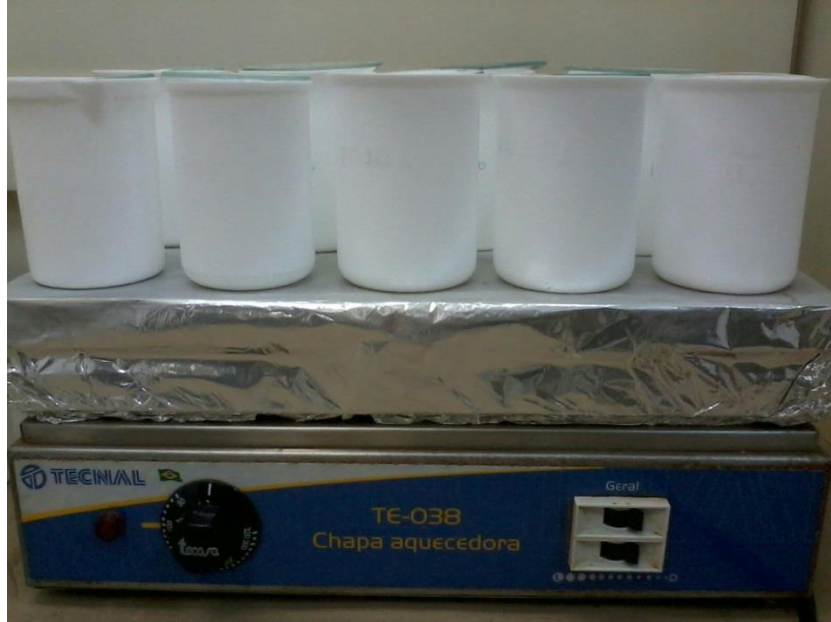
Figura 20- Amostras para redução do volume de água na placa aquecedora em beckers de Teflon a 70 °C
