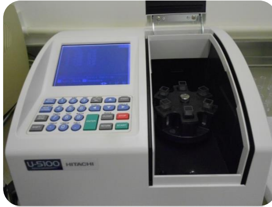
Figura 19- Espectrofotômetro (HITACHI, modelo U-5100), utilizado na determinação do nitrato e sulfato
