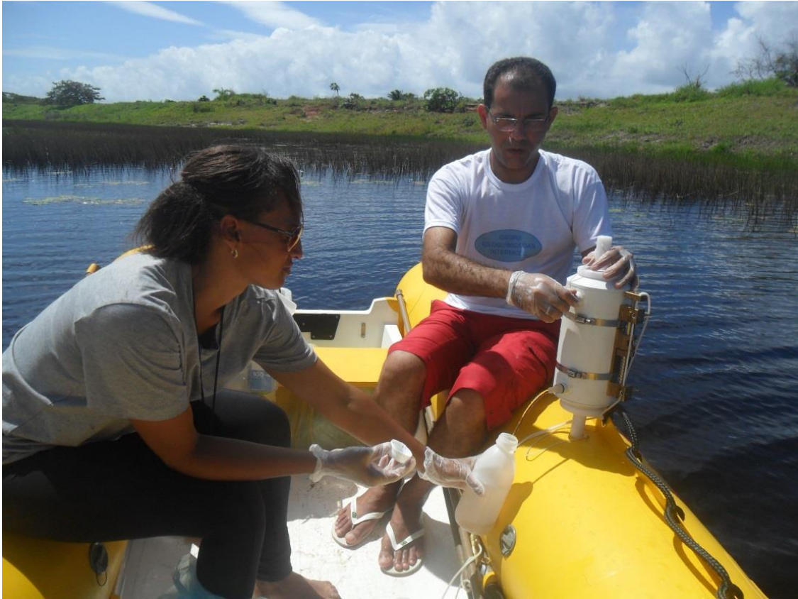
Figura 17- Coleta de água na lagoa Vitória, com garrafa de Van Dohr, para posteriores análises físico-química, química e clorofila-a, em laboratório
