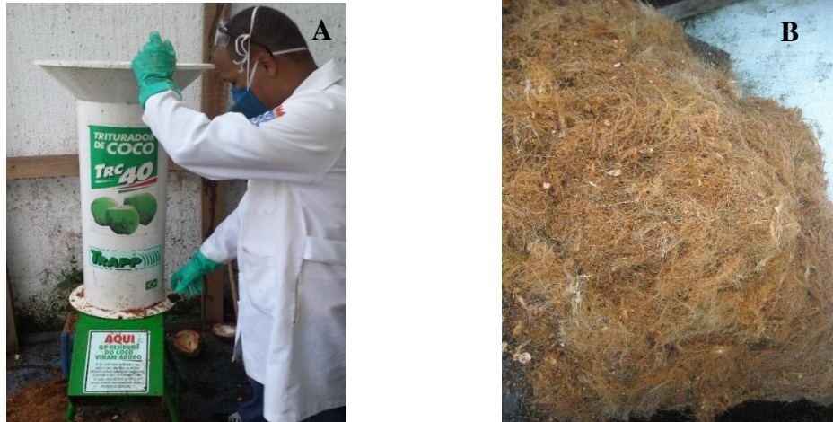
Figura 6. Processamento da matéria prima. (A) Máquina de trituração do resíduo (B) Resíduo depois de triturado.
