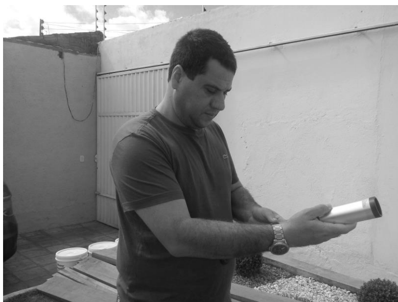
Figura 10 – Calibração do decibelímetro
