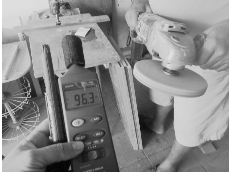
Figura 11 – Medição do nível de ruído durante uso da lixadeira manual
