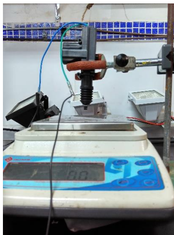
Figura 37 - Montagem para estimar a força da trava elétrica.
