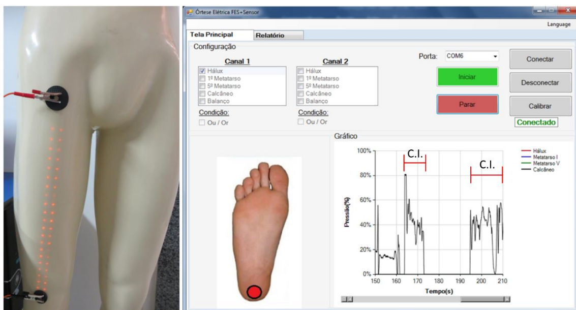
Figura 42 - Exemplo da unidade de demonstração ao ativar o quadríceps no contato inicial (C.I.).
