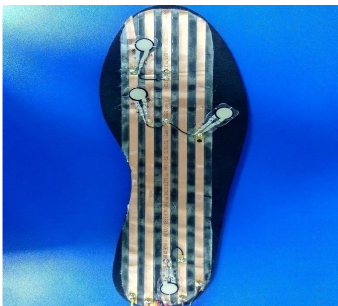
Figura 20 - Versão antiga da palmilha instrumentada.
