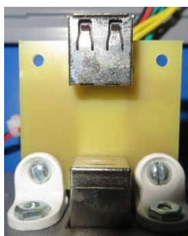
Figura 29 - Circuito para conversão do USB Mini-B para USB B.
