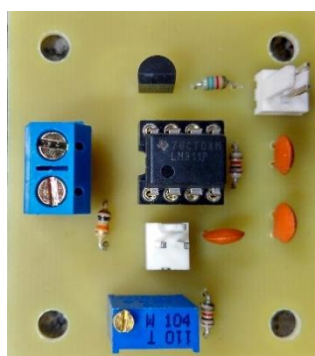
Figura 25 - Circuito de monitoramento da alimentação.
