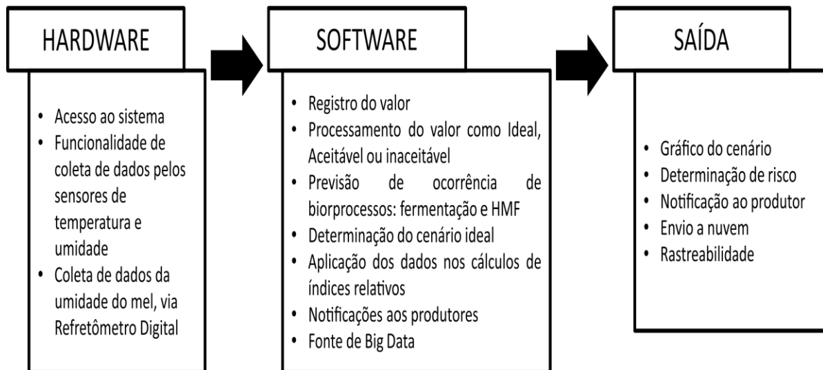
Figura 02: Etapas funcionais do software para os índices de umidade e temperatura.
