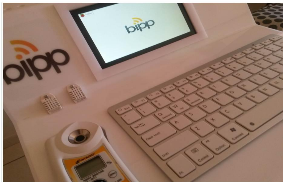
Figura 05: Protótipo do hardware, denominado Módulo BIPP, desenvolvido para embarcar os sistemas de registro, controle e transmissão de dados, a partir das UEPAS.
