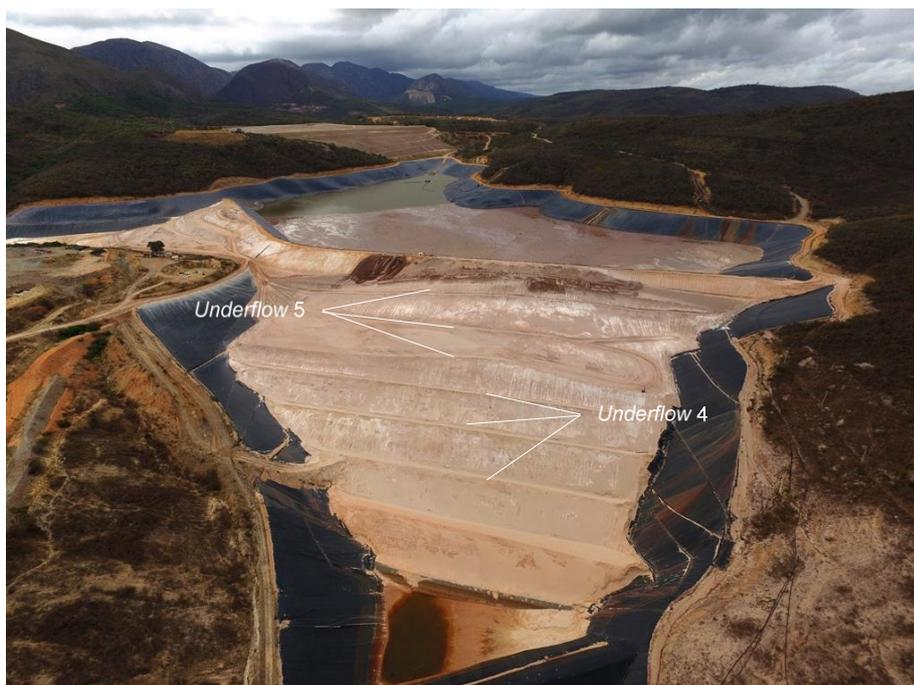
Figura 4.6. Pontos de amostragem no maciço de jusante da B2 (JMC, 2016 (modificado)).
