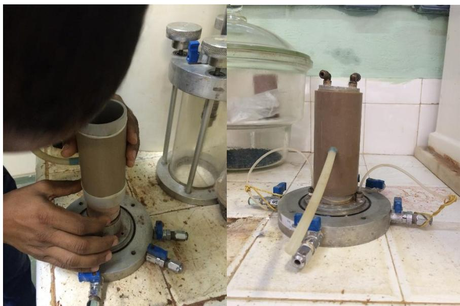
Figura 4.13. Procedimento de inserção da membrana no corpo de prova. Fonte: O autor.
