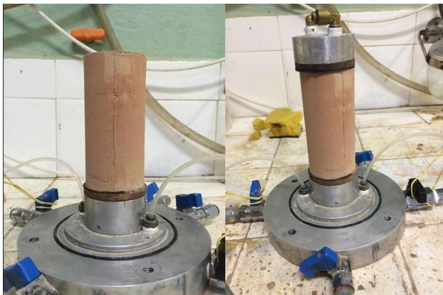
Figura 4.12. Corpo de prova sendo montado na base da câmara triaxial. Fonte: O autor.
