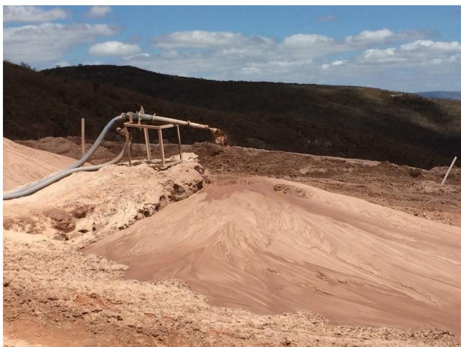
Figura 2.3. *Underflow* do processo de hidrociclonação. Fonte: O autor.
