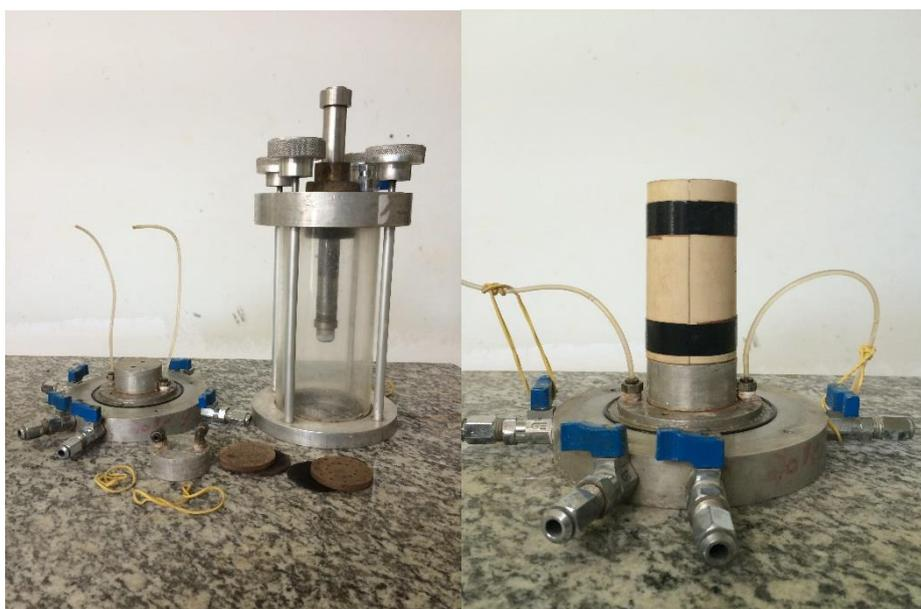
Figura 4.11. Câmara triaxial e corpo de prova ainda com o PVC. Fonte: O autor.
