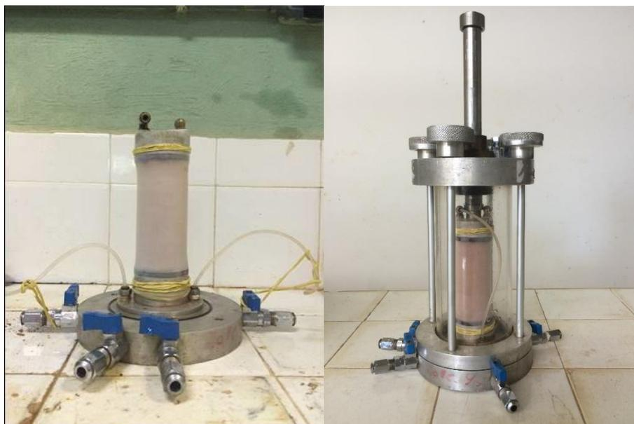
Figura 4.14. Corpo de prova preparado para realização do ensaio. Fonte: O autor.
