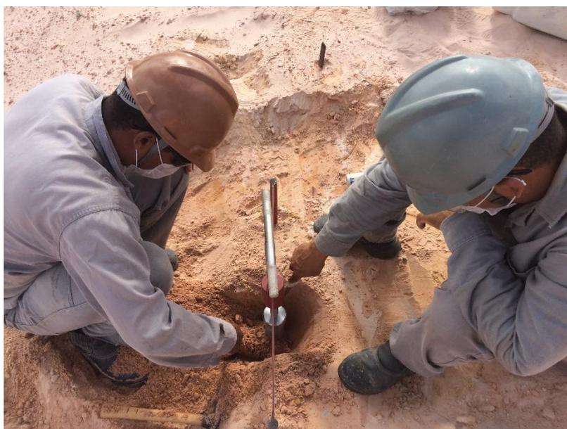
Figura 4.9. Procedimento de amostragem do *underflow*. Fonte: O autor.
