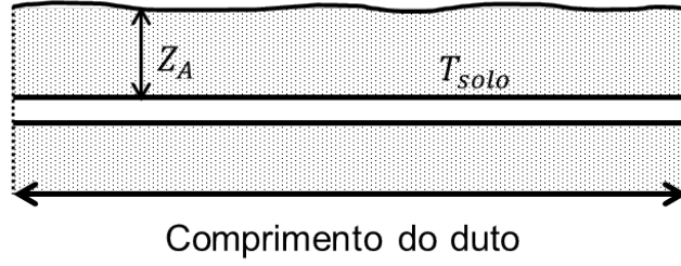
Figura 5.2: Diagrama de um duto enterrado, cuja sua distância à superfície vale Z_A
