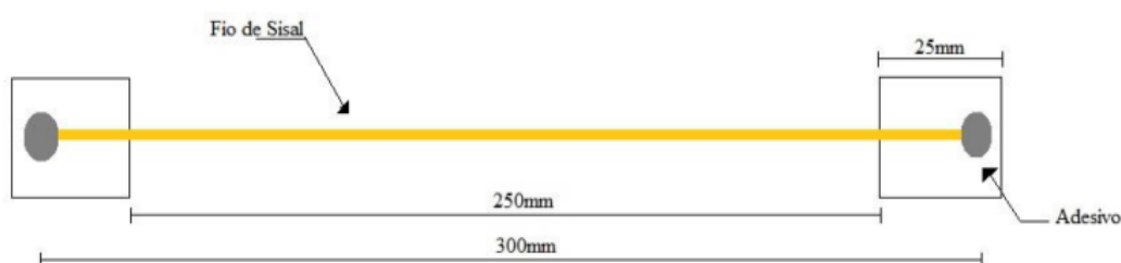
Figura 20. Ensaio de tração do fio de sisal.
