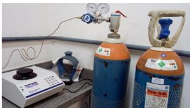
Figura 19. Equipamento para análise de picnometria à gás hélio.
