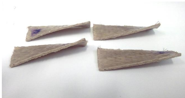
Figura 48. Alteração dimensional dos compósitos CT após imersão em água.
