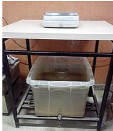
Figura 23. Recipiente metálico acoplado a uma balança hidrostática.
