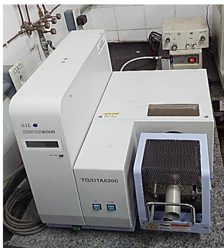
Figura 18. Equipamento para análise de termogravimetria.
