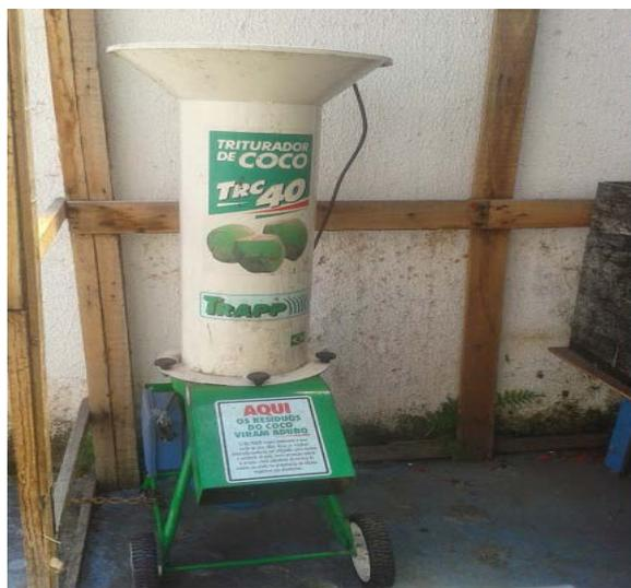
Figura 2. Máquina utilizada para triturar o resíduo de coco e poda de árvore.
