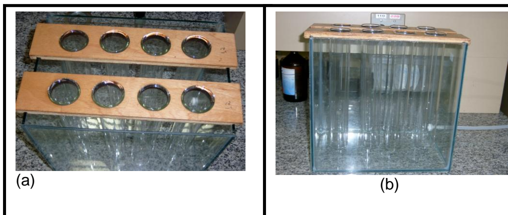
Figura 3 - Aquário com tubos de ensaio sustentados em barras de madeira (a) vista em planta, (b) vista em perfil.
