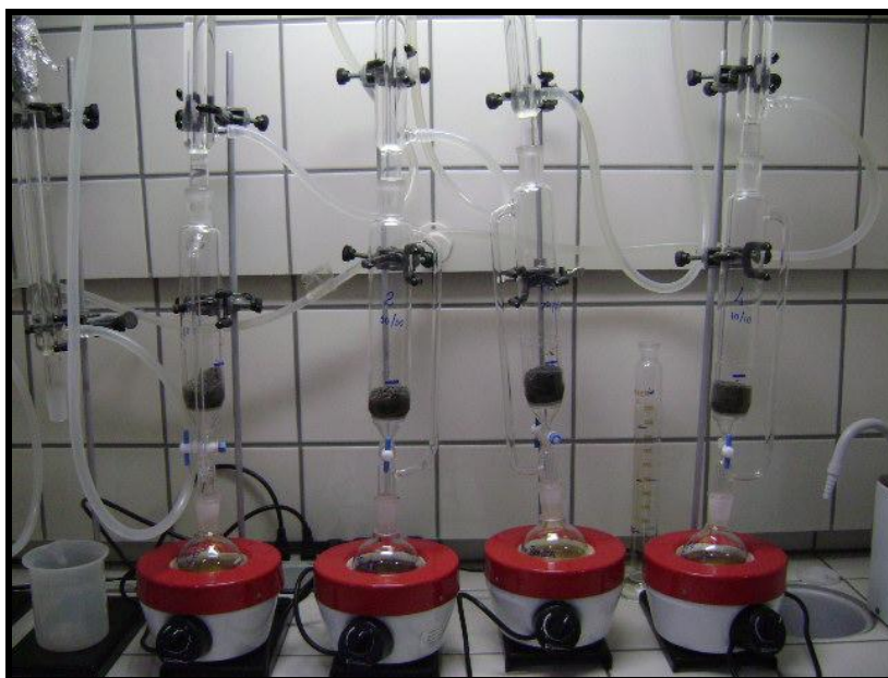
Figura 15 - Sistema Soxhlet utilizado na extração dos hidrocarbonetos contidos nos sedimentos retirados dos aquírios de simulação.
