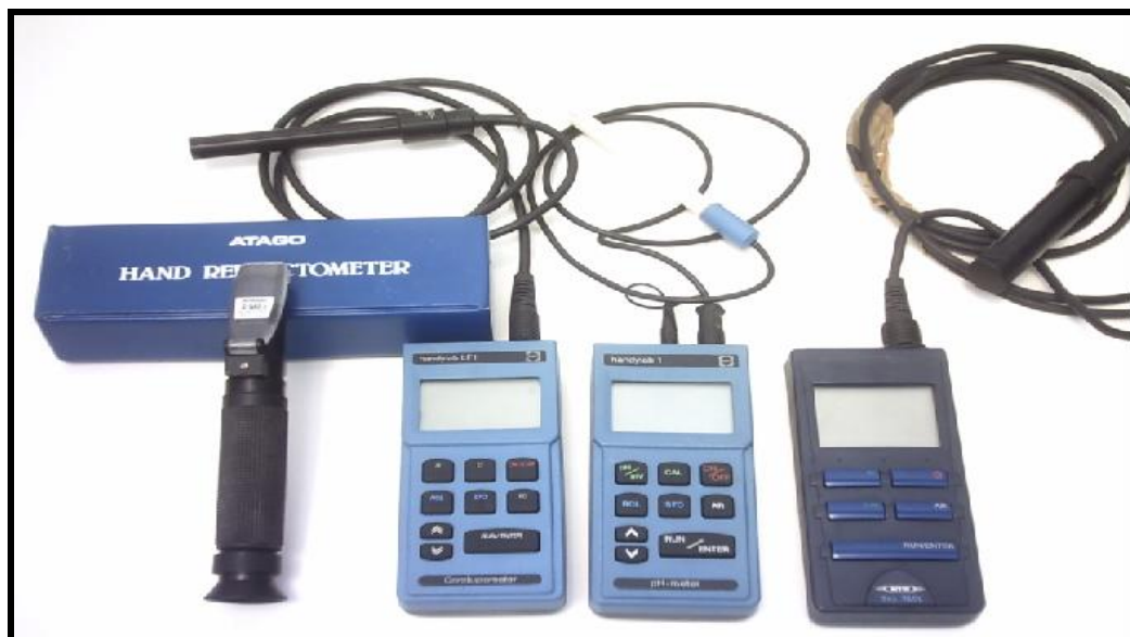
Figura 14 - Equipamentos utilizados para mensurar os parâmetros físico-químicos. Da esquerda para a direita: refratômetro, condutivímetro, pH-metro e oxímetro.
