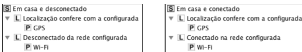
Figura 3.4 Algumas situações descobertas pelo Analisador de Modelo na aplicação exemplo. Cada situação [S] possui dois contextos lógicos [L] e cada contexto lógico está associado a um contexto físico [P], o qual representa o sensor.
