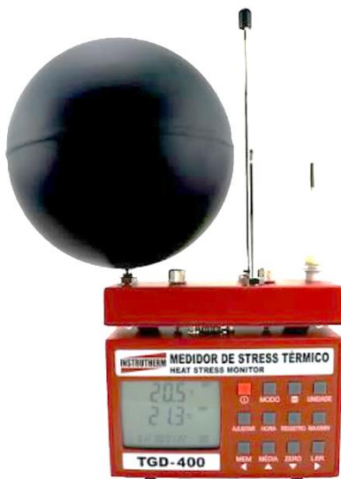
Figura 11: medidor de estresse térmico utilizado na pesquisa. INSTRUTHERM Mod. TGD 400.
