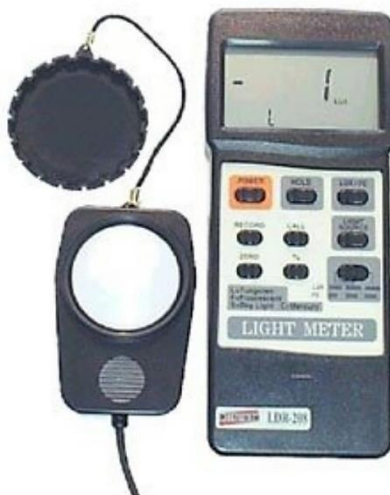
Figura 12: medidor de intensidade luminosa (luxímetro) utilizado na pesquisa. INSTRUTHERM Mod. LDR 208.
