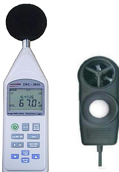
Figura 10: medidor de nível de pressão sonora utilizado na pesquisa. INSTRUTHERM Mod. DEC 480 com sonda.
