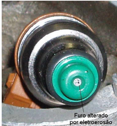
Fig. 4.3 – Válvula injetora com vazão ampliada através de eletro erosão
