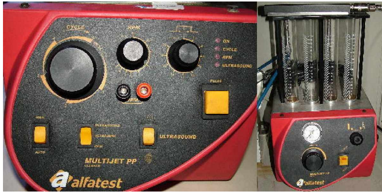
Fig. AII.6 - Equipamento para calibração dos eletroinjetores
