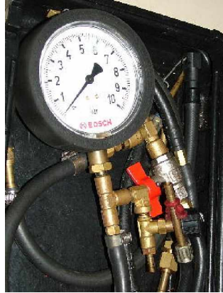
Fig. 4.10 – Manômetro de pressão de combustível
