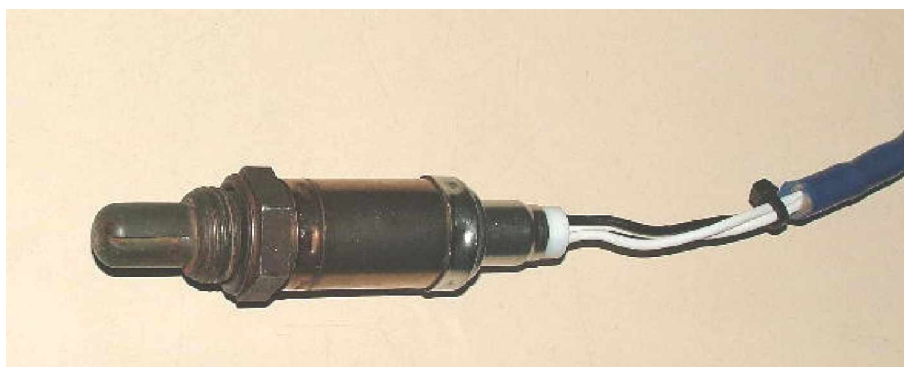
Fig. 2.7 - Sensor de oxigênio típico
