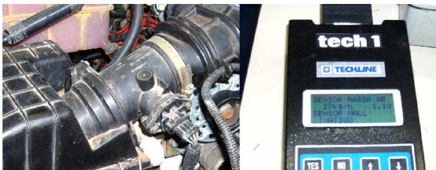
Fig. 5.2 – Medição da massa de ar admitida – sensor e respectivo valor captado
