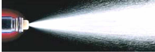
Fig. I.13 – Aspecto do combustível saindo do Bico injetor
