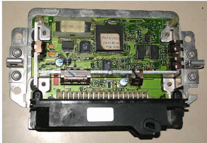
Fig. I.35 – Central eletrônica de gerenciamento do motor Bosch Motronic M 2.8.1
