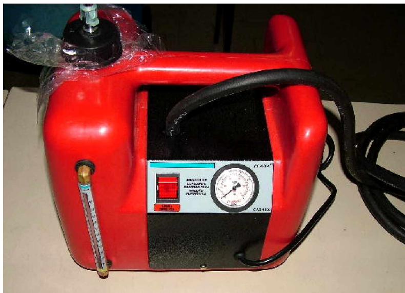
Fig. 4.9 – Bomba e controle de combustível
