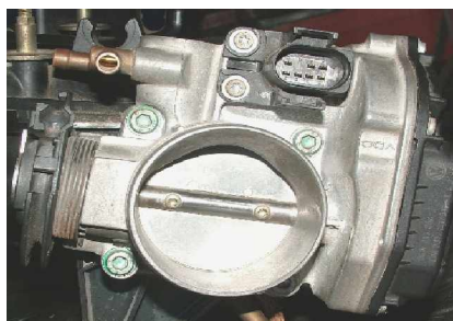
Fig. I.15 – Borboleta de aceleração
