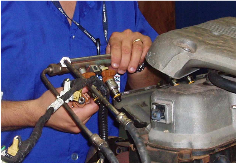
Fig.4.6 – A operação de substituição das válvulas injetoras foi facilitada pela arquitetura do motor
