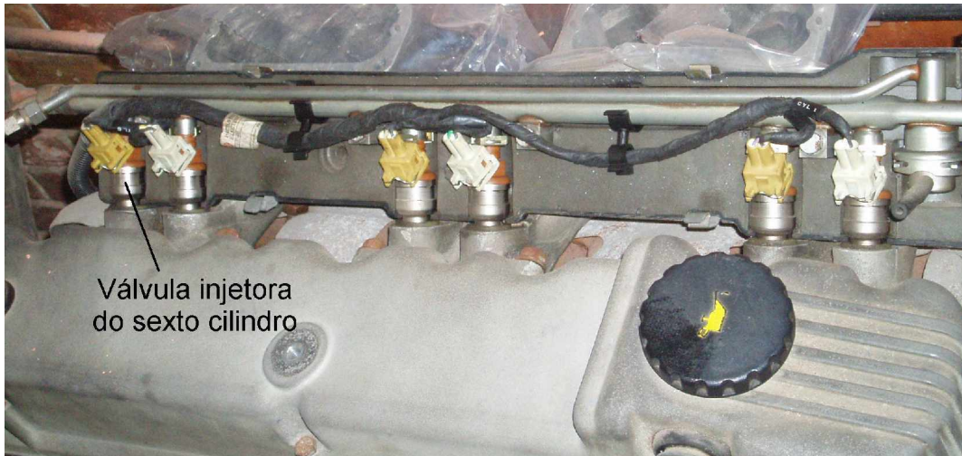
Fig. 4.2 – Localização do sexto cilindro facilita substituição da válvula injetora
