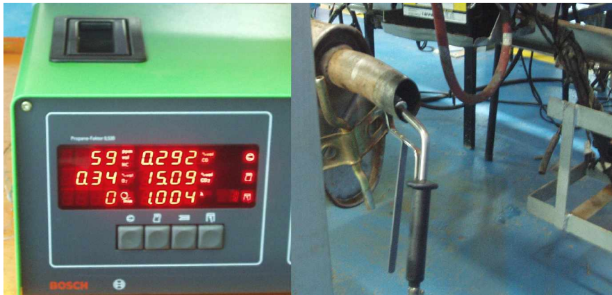
Fig. 4.11 – Analisador de gás com respectiva sonda instalada no escapamento
