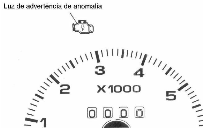
Fig. I.11 – Exemplo de luz piloto de avaria no sistema de gerenciamento – adaptada de [GM a, 1995]
