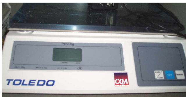
Fig. 5.1 – Balança foi utilizada para medir consumo de combustível
