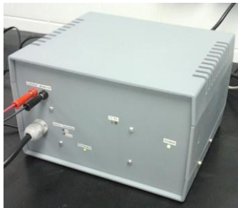
Figura 1. Imagen del equipo de adquisición de datos para tests en corriente constante de baterías de plomo-acido.
