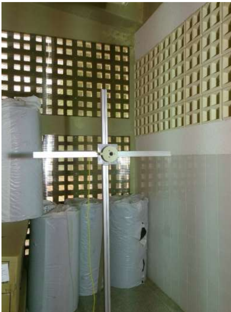
Figura 17. Radiômetro instalado normal à lâmpada na primeira configuração de teste.
