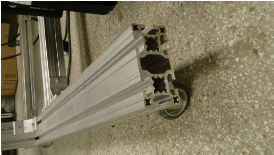
Figura 16. Perfil de alumínio estruturado ENGELEGHO de 40x80 mm.
