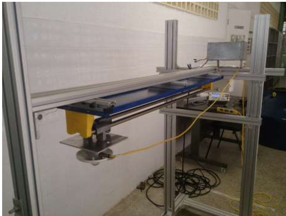
Figura 20. Configuração de testes com radiômetro em suporte móvel voltado para baixo.
