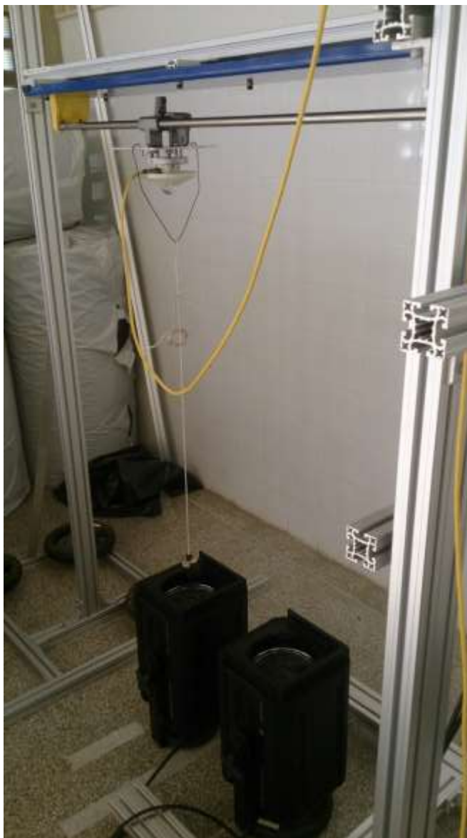
Figura 23. Prumo anexado ao radiômetro para alinhamento vertical.
