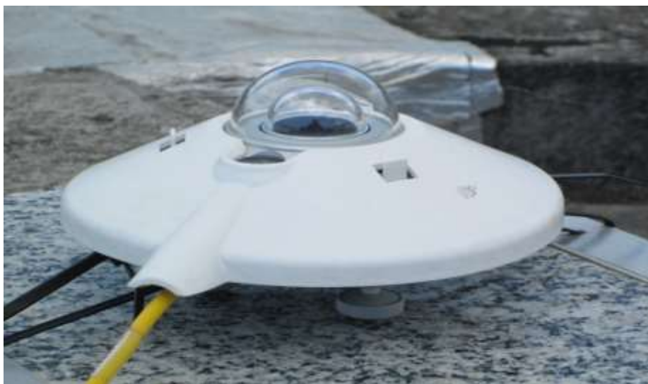
Figura 4. Piranômetro CMP-21 da empresa Kipp & Zonen.
